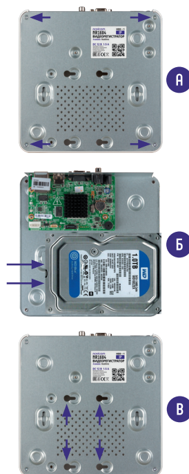
Рис. 2 Установка жесткого диска для NR1604 | NR1604-P4 | NR1608 | NR1608-P8
